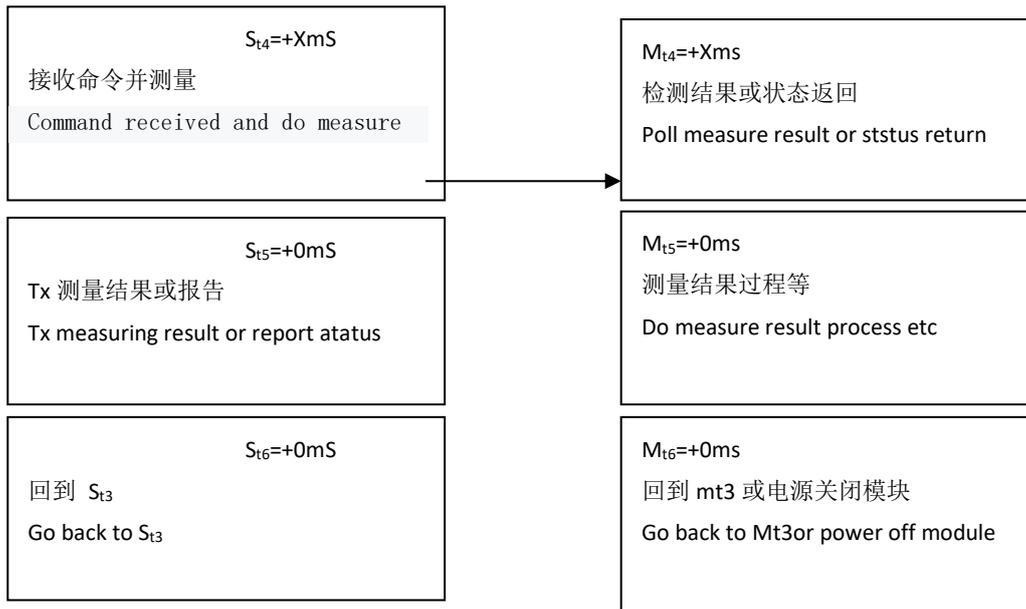
图 5-1 控制流程
