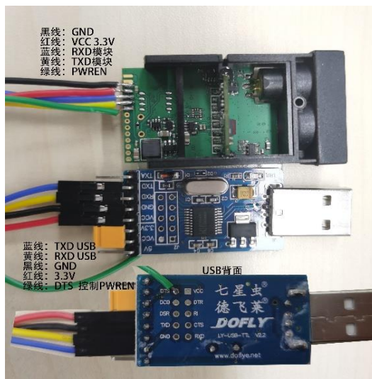
图 4-2 显示，TTL-USB 模块 TXD/RXD 没有接上拉电阻，是因为 USB 转换器 TXD/RXD 引脚内部具有上拉电阻器；绿线 PWREN 可以不接；
